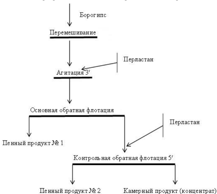
Рис. 2. Схема обратной флотации борогипса с использованием перластана
