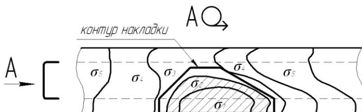
Рис. 1. Поля напряжений на развороте участка рамы с установленными усилительными накладками
