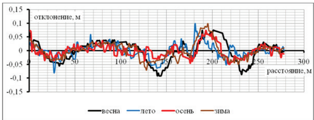
Рис. 1. Сезонные профили грунтовой дороги «ДСК – ПТФ»
