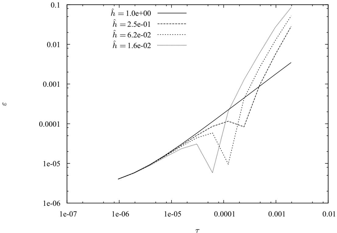
Рис. 1: Зависимость погрешности факторизованной схемы от шага по времени при  $\sigma = 1$ .
