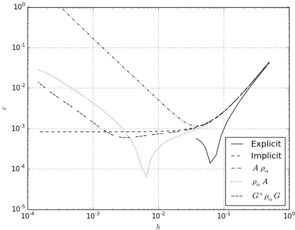
Рис. 3: Зависимость нормы погрешности факторизованных схем от шага по пространству для различных операторов декомпозиции.
