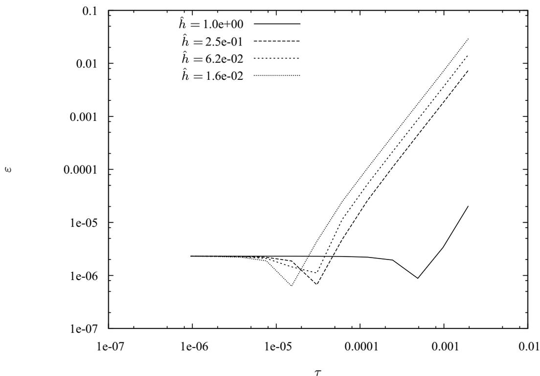
Рис. 2: Зависимость погрешности факторизованной схемы от шага по времени при  $\sigma = 0.5$ .
