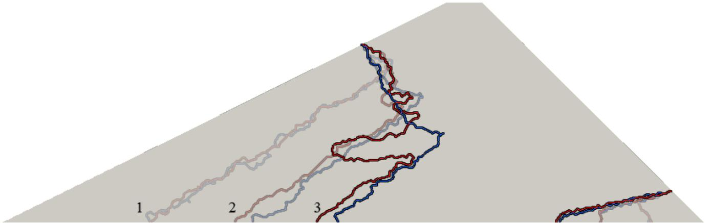
Рис. 5: Движение границы насыщенного грунта в 1-й, 2-й, 3-й день. Синяя линия – без противодиффузионного экрана, красная – с экраном.
