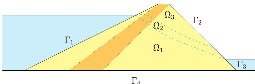
Рис. 4: Границы и подобласти земляной плотины с противофильтрационным экраном.
