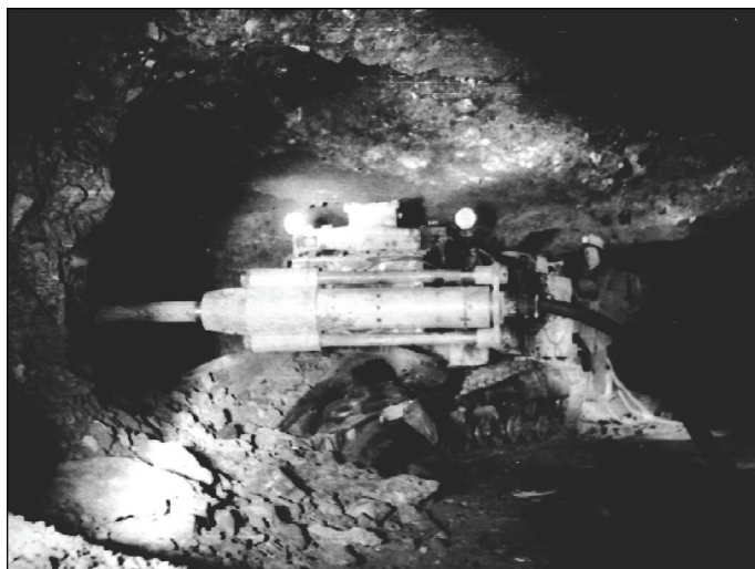
Рис. 4.10. Проходческий комбайн ГПКС с навесным пневмомолотом ПН-1700 в шахте «Омолойд»
