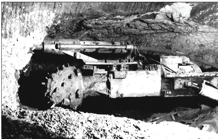
Рис. 4.18. Экспериментальный исполнительный орган проходческого комбайна в шахте
