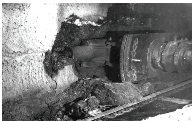
Рис. 4.22. Экспериментальный исполнительный орган очистного комбайна в шахте
