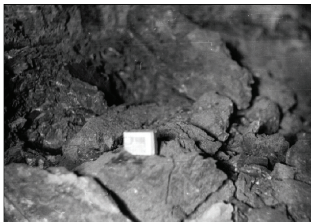
Рис. 4.13. Куски отколотой породы после ударного разрушения.
