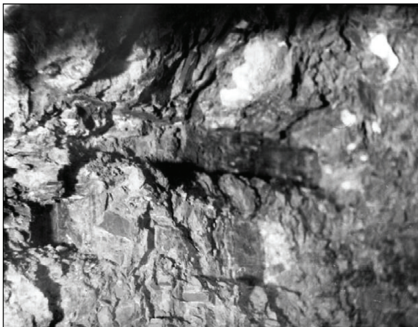
Рис. 4.14. След в забое после блокированного разрушения
